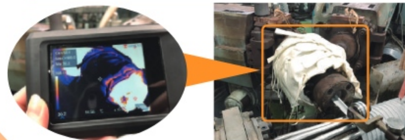
ข้อมูลก่อน-หลังหุ้มผ้าฉนวนกันความร้อน
