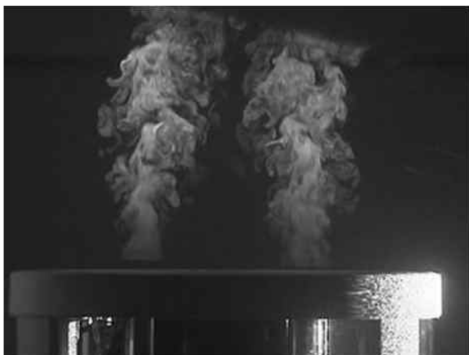
図4 ナノシード \alpha の放出粒子による煙の動き（その2）
